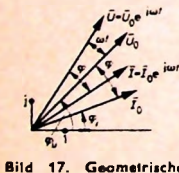
Bild 17. Geometrische Veranschaulichung des Ohmschen Gesetzes für Wechselspannungen
